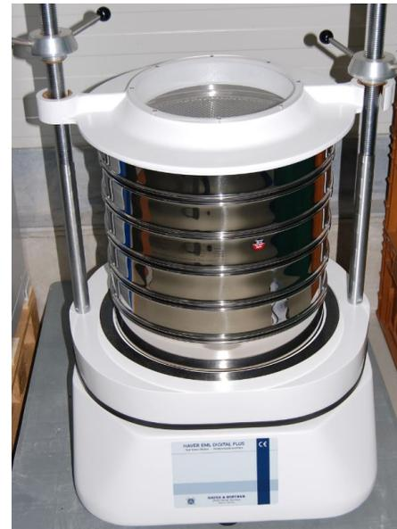
© fBB | Vibrationssiebmaschine
